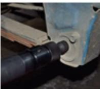
Mit dem runden Meißel können z.B. angerostete Bolzen durchgetrieben werden.
