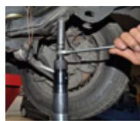
Der 12,5 mm (1/2") Adapter Meißel dient unterstützend zum lösen von festgerosteten Schrauben und Muttern.
