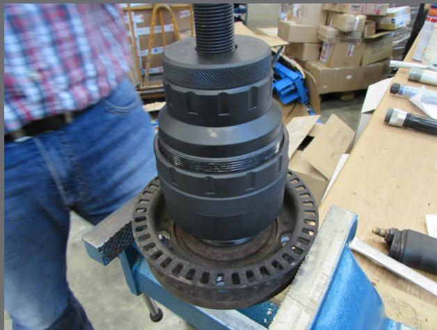
5. Anschließend verspannen Sie die Abzieherglocke auf der Lagerschale indem Sie mit den Ringschlüsseln das Abziehergehäuse und die Druckhülse fest verschrauben.
