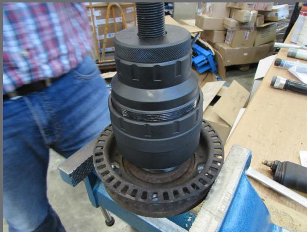
5. Serrez ensuite la cloche d'extraction sur le coussinet de palier en vissant fermement le boîtier d'extracteur et la douille de pression avec les clés annulaires.
