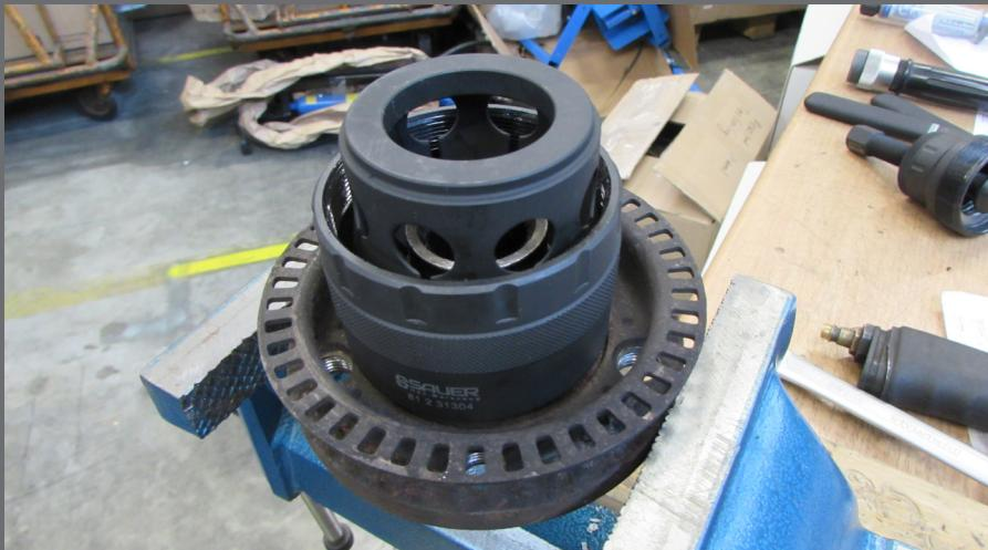
3. Vissez la vis de pression dans le boîtier d'extracteur.
