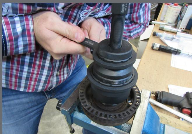
6. Assurez-vous que la cloche d'extraction est fermement serrée sur le coussinet de palier. En faisant tourner la vis, vous pouvez maintenant extraire le coussinet de palier.
