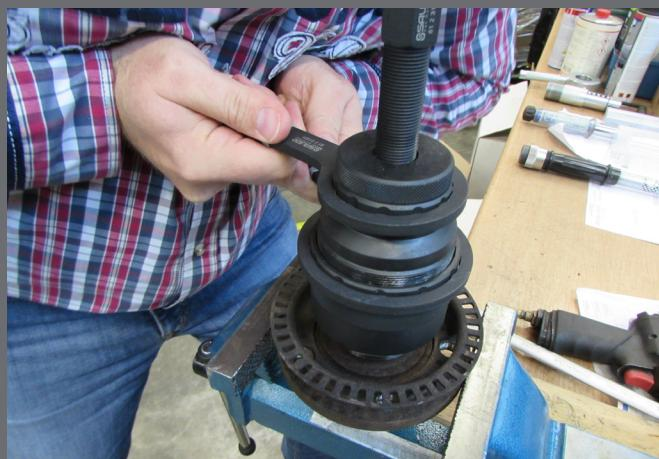
6. Vergewissern Sie sich, dass die Abzieherglocke auf der Lagerschale fest verpresst ist. Durch drehen der Spindel kann nun die Lagerschale abgezogen werden.
