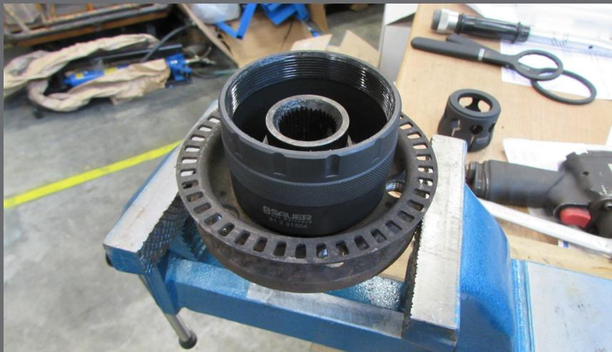
2. Wählen Sie die passende Abzieherglocke aus und setzen Sie sie möglichst Nah am Bund der Lagerschale an.
