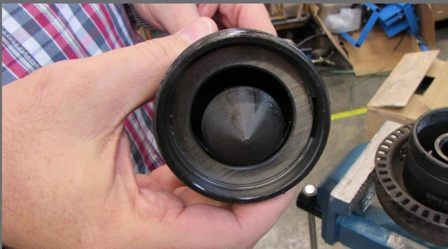
4. Schrauben Sie das Abziehergehüse in die äußere Druckhülse.
