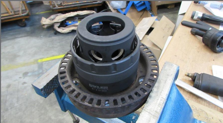
3. Schrauben Sie die Druckspindel in das Abziehergehäuse.
