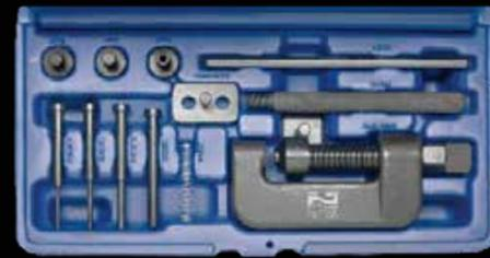
TRENNEN VON HOCHLEISTUNGS-KETTEN 530 ODER HÖHER NUR NACH ABSCHLEIFEN DES NIETEN-KOPFES!
