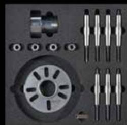
Werkzeugsatz zur Adaptierung der Radnabe für Auszieh-/ Auspressarbeiten der Gelenkwelle und der Radnabe. In Verbindung mit hydraulischem oder manuellen Druckwerkzeug und Schlaghammer.
